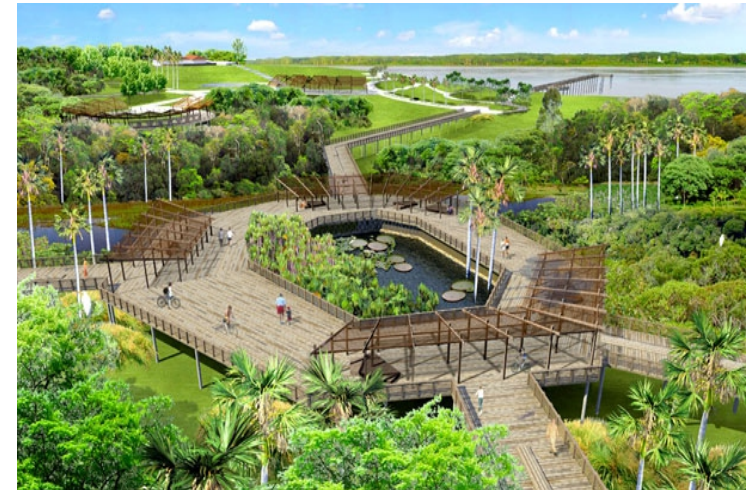
Figuras 150: Grande deck elevado sob palafitas permite o acesso durante o período de cheia do Rio Madeira.
